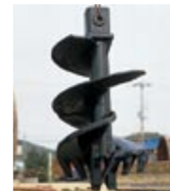
スクリーヘッド掘削作業
